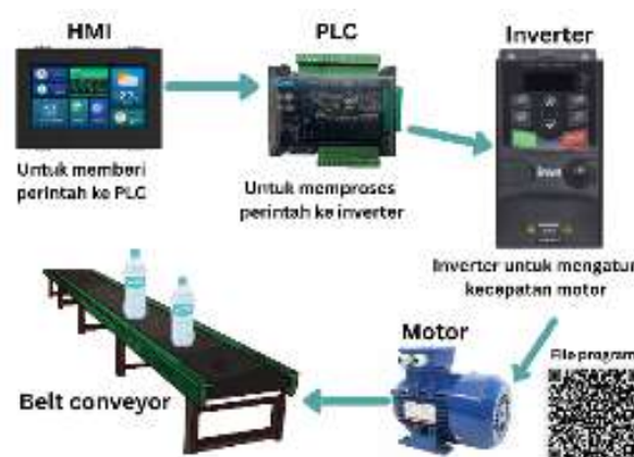
Gambar 1. Skema cara kerja sistem
