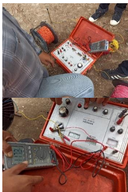
Gambar 3. Alat geolistrik untuk menentukan kedalaman air tanah
