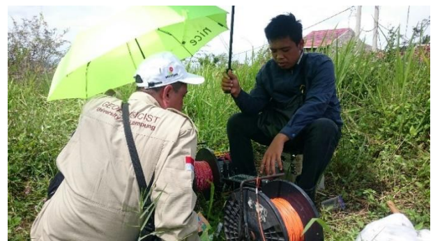
Gambar 3. Proses pengukuran di titik SPN 3 untuk mendapatkan posisi air tanah di bawah permukaan
