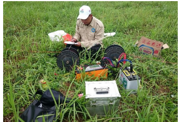
Gambar 2. Peralatan ARES dan pendukung untuk pengukuran geolistrik sounding 1D (VES)
