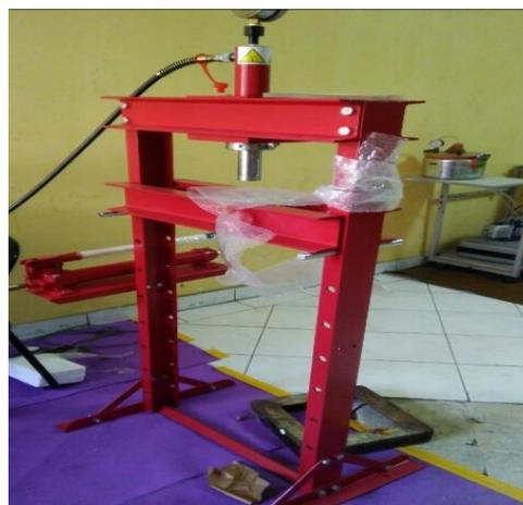
**Gambar 2.** Mesin press untuk menekan kuningan kedalam cetakan.
