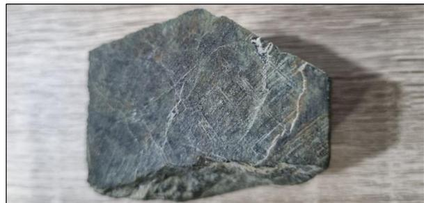
**Gambar 3.** Batuan yang telah dilakukan preparasi dan siap untuk dilakukan pengujian dengan menggunakan micro-XRF. Sampel yang digunakan untuk analisis berupa sampel batuan serpentinit yang merupakan batuan metamorf non-foliasi. Batuan ini metamorfisme dari batuan peridotit ultrabasa. Ukuran sampel dengan panjang 8 cm, lebar 6 cm, dan tinggi 4 cm
