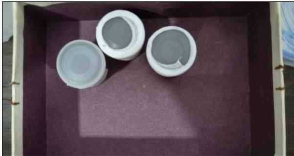
**Gambar 4.** Sampel serbuk yang sudah dimasukkan dalam wadah preparasi. Kemudian diletakkan dalam wadah alat micro-XRF (Gambar 5)
