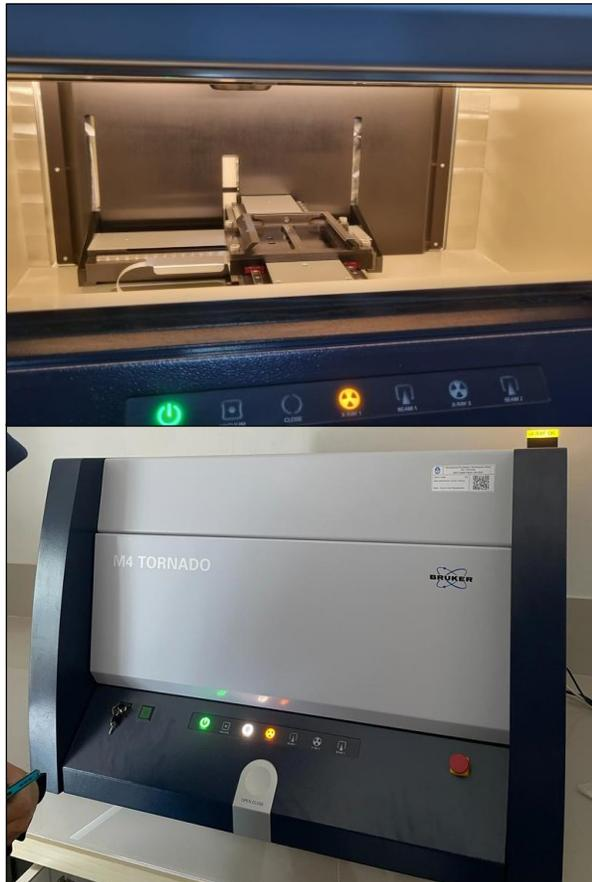
**Gambar 5.** Alat micro-XRF dari Bruker dan Dynatech
