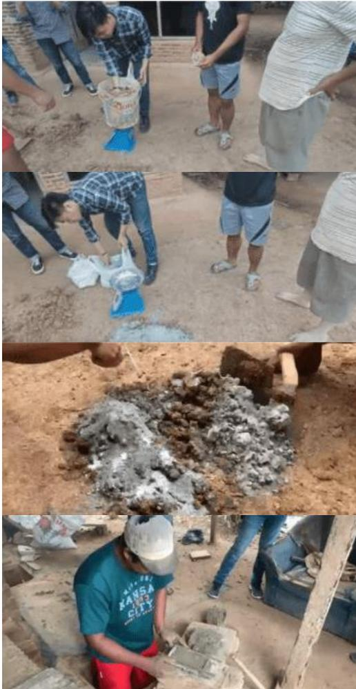
**Gambar 3.** Proses produksi bata merah, (a) menimbang tanah, (b) menimbang bahan tambah (zat aditif), (c) proses pencampuran, (d) proses pencetakan.
