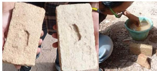
**Gambar 5.** Pengamatan dan pengujian bata merah, (a) perbedaan dimensi bata merah, (b) proses pengujian pelapukan.
