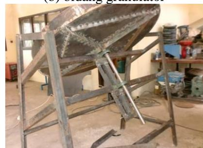
(c) granulator sebelum pengecatan
